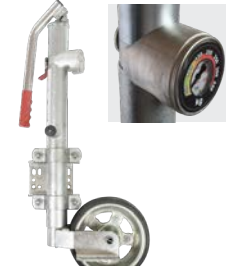
Stützrad mit hydraulischer Pumpvorrichtung inkl. Stützlastanzeige mit flexibler Anschraubplatte mit Federriegel Trittkralle für schnelles Ausfahren Vollgummirad mit Metallfelge Radgröße 230 x 80 mm Statische Stützlast 600 kg Rohrlänge 590 mm, Rohr-Ø 60 mm Hub 360 mm
