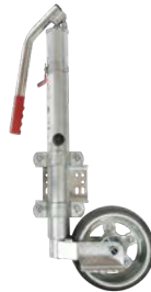
Stützrad mit hydraulischer Pumpvorrichtung mit flexibler Anschraubplatte mit Federriegel Trittkralle für schnelles Ausfahren Vollgummirad mit Metallfelge Radgröße 230 x 80 mm Statische Stützlast 600 kg Rohrlänge 590 mm, Rohr-Ø 60 mm Hub 360 mm
