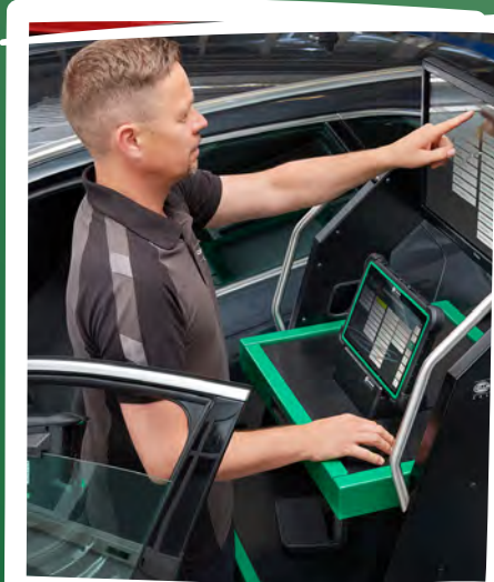
Fehlersuche mit dem mega macs-Diagnosegerät am Fahrzeug.
